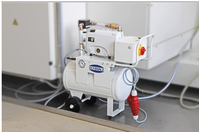
Вакуумный агрегат VAGG для создания вакуума при мокрой обработке
